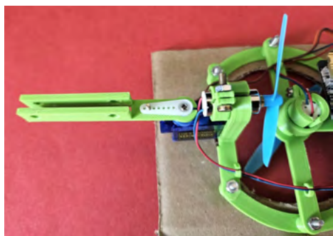
Slika 50.19. Za spajanje nosača kormila koristite dijelove i vijke koje ste dobili uz servomotor
