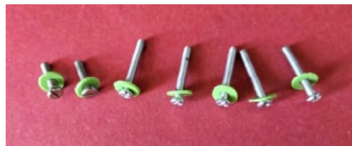
Slika 50.6. Na ovih sedam vijaka idu 3D-printani podlošci
