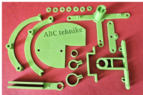
Slika 50.2. Ovo su svi elementi koje trebate 3D printati
