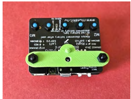
Slika 50.13. Nosač pričvrstite plastičnim vijcima i maticama za BBC micro:bit i Black bord
