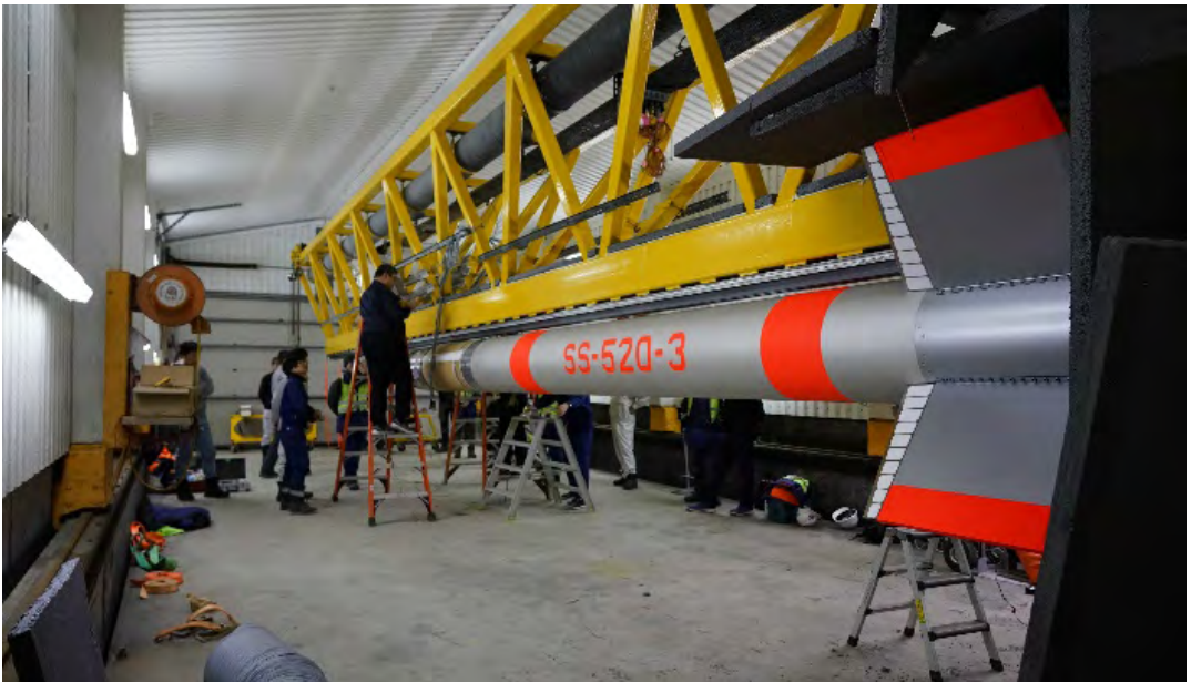
Slika 1. Namještanje drugog stupnja i telemetrijske opreme na raketi SS-520-3 (Izvor: privatna kolekcija slika Y. Saito)
