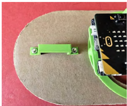
Slika 50.15. Nosač baterije ide na kraće vijke M3 × 10
