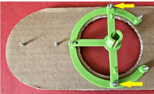
Slika 50.10. Trup usmjerite kako je vidljivo, a zatim ga pričvrstite s dvije matice M3 (žute strelice)
