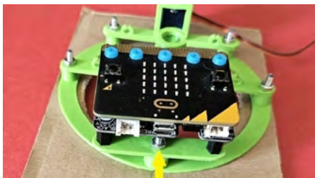
Slika 50.14. Za pričvršćivanje ove matice (žuta strelica) pomognite si pincetama
