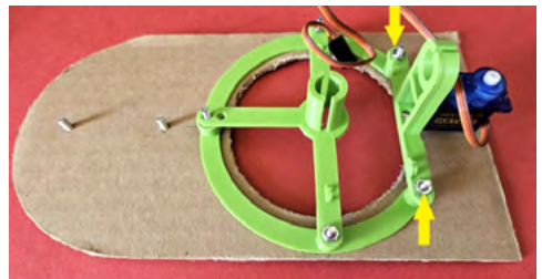
Slika 50.12. Nosač motora usmjerite kako je prikazano, a zatim ga pričvrstite s dvije matice M3 (žute strelice)
