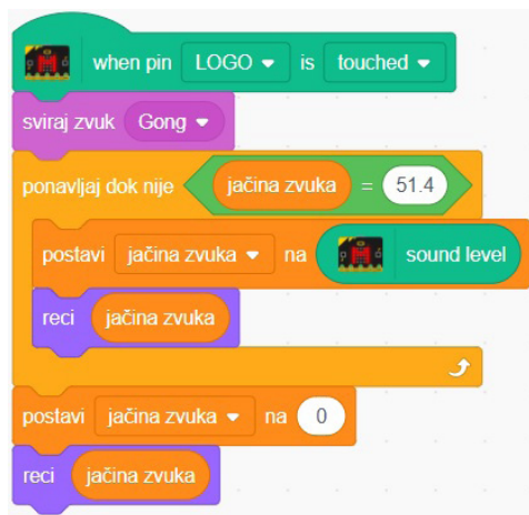
Slika 56.6. Programski kôd koji će pokrenuti zvuk na zvučnicima računala i koji će pokrenuti mjerenje jačine zvuka preko osjetila BBC micro:bita
