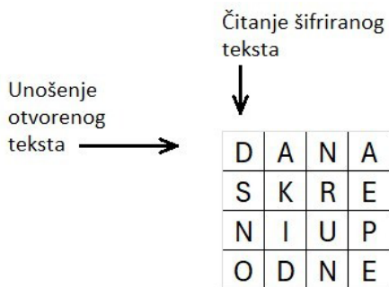
Slika 3. Prikaz tablice (rešetke) za transpozicijski sustav Skitala za ključ 4
