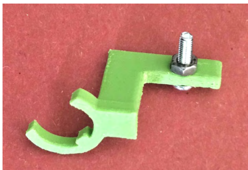
Slika 49.2. 3D-printani držač osjetila
