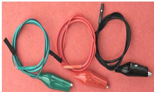
Slika 49.4. Za spajanje osjetila s BBC micro:bitom trebate pripremiti tri vodiča, crveni za plus pol, crni za minus pol i zeleni (ili neka druga boja) za signal
