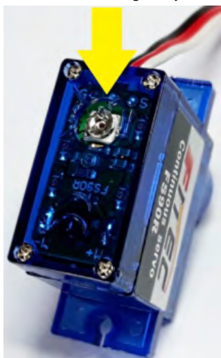
Slika 51.16. Na poleđini servomotora nalazi se polupromjenjivi potencijometar za fino ugađanje
