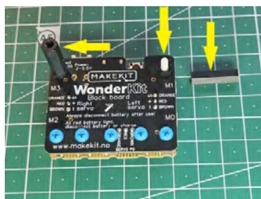
Slika 51.8. Kad dvije pločice spojite prema uputama u “sendvič”, na bijele plastične vijke zavrnite dvije odvojene matice koje ste također dobili u kompletu
