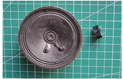
Slika 55.13. Lijevo – uobičajeni zvučnik, desno – piezo-zvučnik
