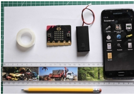
Slika 55.3. Za izradu glazbenog instrumenta trebate BBC micro:bit i pripadajuće baterije, bijeli papir, selotejp i mobilni telefon. Osim toga, prilikom izrade trebati će vam olovka, ravnilo, a možda i škare
