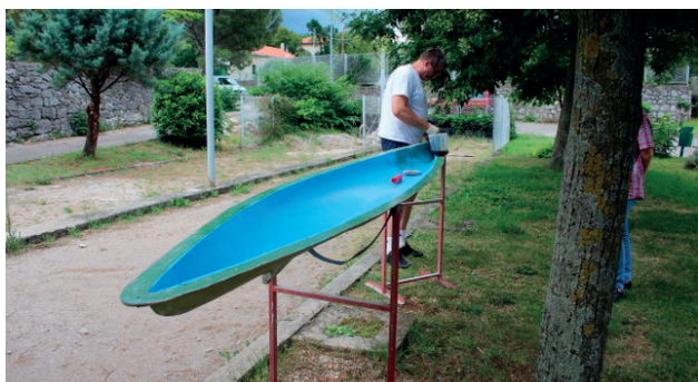
Nanošenje gel coata koji daje vanjski izgled kajaku i osigurava vodonepropusnost.
