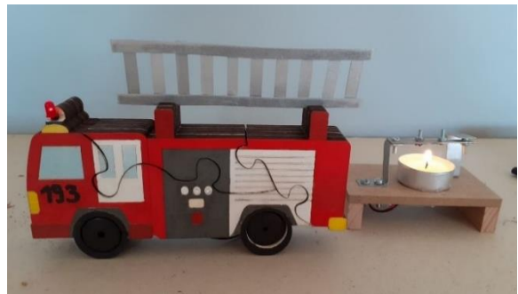
Vatrogasno vozilo - bimetal kao sklopka
