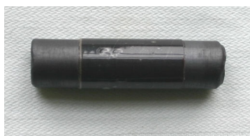
Na feritnu jezgru namotati samoljepljivu traku širine 25mm
