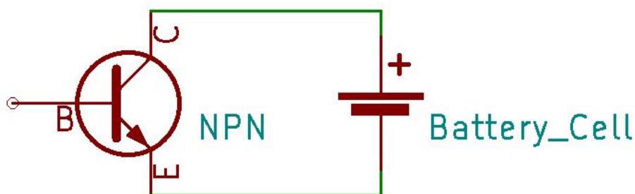
Slika 3. Emiter NPN tranzistora ide na negativan pol napajanja.
