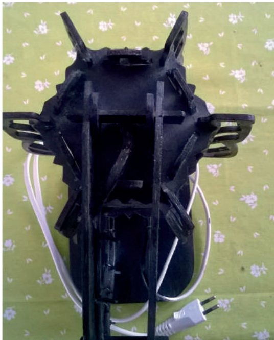
Pogled odozgo na spoj rasvjetnog dijela i nosača.
