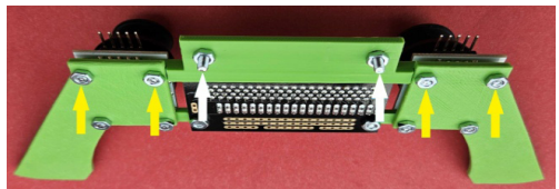
Slika 48.3. Svi dodani vijci su M3 × 10. Primijetite da vijci označeni bijelim strelicama donekle strše
