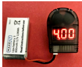
Slika 44.5. Specijalni voltmetar za mjerenje napona pojedinih ćelija Li-Po baterije
