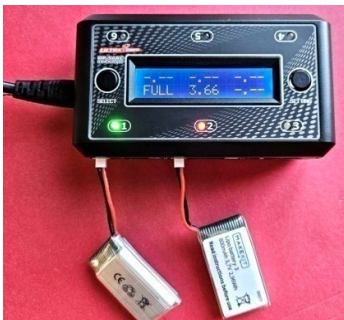
Slika 44.4. Ovaj punjač omogućava istovremeno punjenje do 6 komada 1S Li-Po baterija
