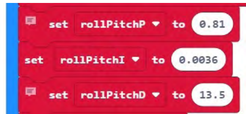
Slika 46.4. Ovako izgledaju blokovi nakon posljednje promjene PID parametara
