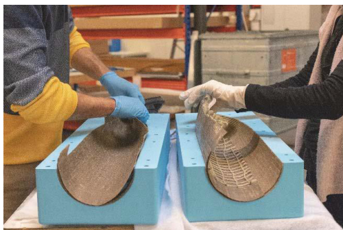
Slika 7. Izradba vrha u dvodijelnom kalupu. Izvor: Izveštaj projekta EIGER
