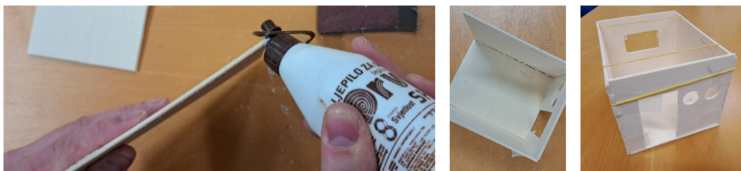
Slika 4. Postupak lijepljenja bridova stranica/pozicija
