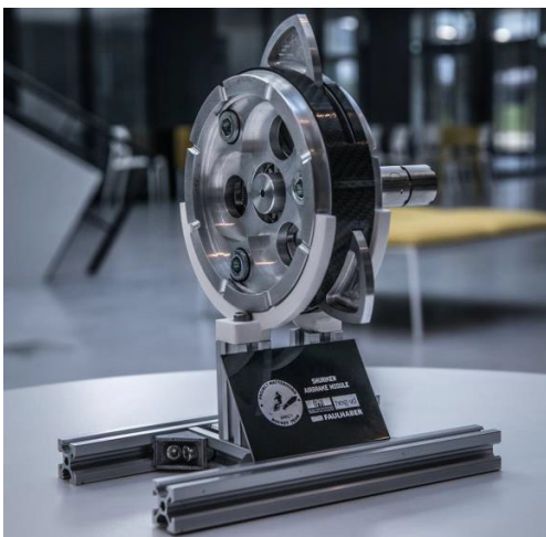
Slika 4. Detaljni prikaz zračne kočnice. Izvor: Detaljni izvještaj projekta
