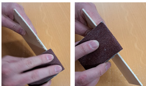
Slika 5. Postupak brušenja brusnim papirom 800
