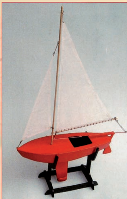
Jedrilica Lucija namijenjena je početnicima. Materijal je uglavnom balzin furnir i šperploča. Ravnog je dna. Izrada je moguća kao model ili izložbena maketa. Pri nabavi materijala obratite se na www.leo-modeli.hr
