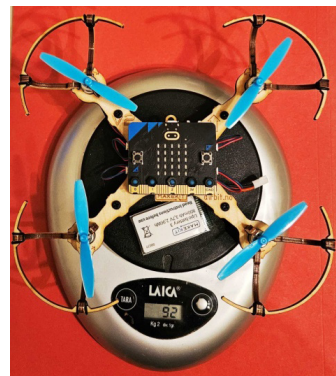
Slika 42.12. Ukupna masa drona Air:bit 2 i Li-Po baterije je 92 grama
