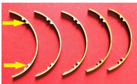
Slika 42.5. Za lakše uglavljivanje štitnika na nosače preporuka je da modelarskom turpijom proširite uture (žute strelice)
