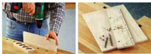
Bušenje uvrta–za prijenos Prikaz izbušenih uvrta prije je moguće “raditi” i s čavli- spajanja ćima
