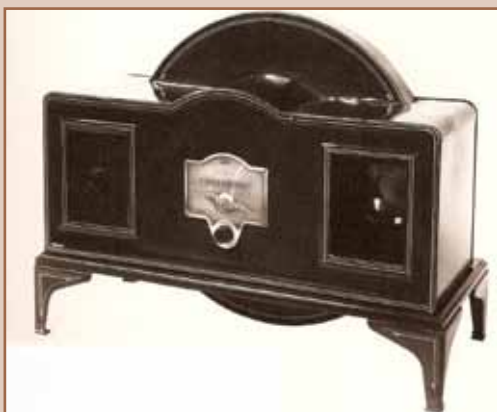
Bairdov Televisor s Nipkowljevim diskom iz 1928. godine, prvi je prijamnik namijenjen tržištu
