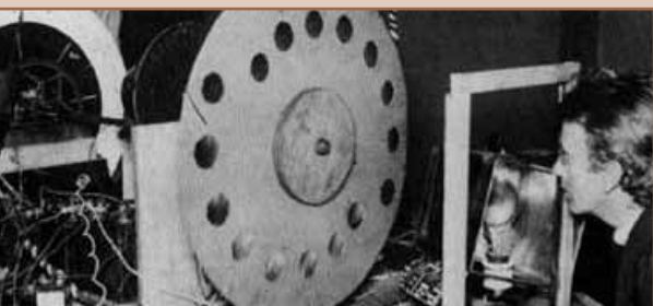
Baird uz svoj pokusni televizijski prijamnik s Nipkowljevim diskom
