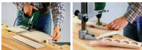
Piljenje ubodnom (povrat- Izrada uvrta sjedišta sta- nom) pilom pod kutom od klenki glodalom promjera 40° 50 mm
