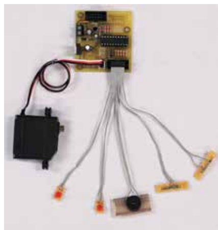
Slika: Kompletna pločica s perifernim jedinicama
